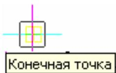
**Найдена объектная привязка:** Когда progeCAD находит элемент с заданными геометрическими свойствами, она выводит желтую иконку под названием «маркер», которая указывает на расположение элемента, всплывающая подсказка описывает элемент (Конечная точка, в данном случае); см. полный список ниже. Вы можете изменить цвет и размер маркера с помощью опции **Курсор привязки** из меню **Сервис | Настройка | вкладка Привязка .)**
