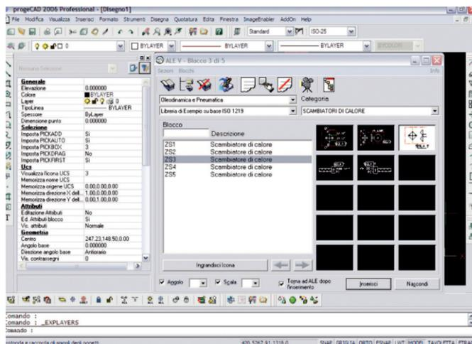
1. In questa immagine si nota il feeling dell'interfaccia di progeCAD con il più famoso AutoCAD. In primo piano si nota il modulo ALE per la gestione delle librerie di blocchi. Di base il programma ne fornisce oltre 10.000.
